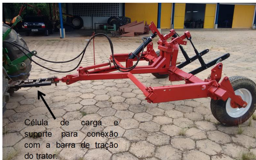
FIGURA 2. Versão final do protótipo e suporte para conexão com a barra de tração.
